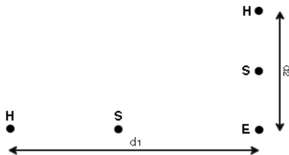
如果您经过多次测量测得了相同的数值，那么您的测量结果是正确可靠的。如果测量数值相差很大，那么可能是辅助电极受到**感应电流**或是地下水路的影响。此时您可以通过将辅助地桩打得更深一些和/或 将地桩周围的土壤弄湿以减小辅助电极和土壤之间的接触电阻，以增加测量的准确可靠性。
