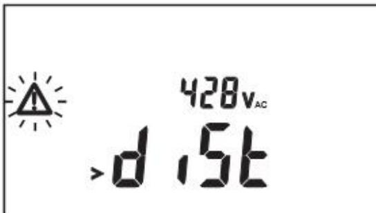
端子上的干扰电压太高以至于无法测出：干扰电压>0.4 Un。
