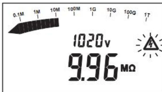
按 START/ STOP 键再次停止测量。该仪器继续测量外部电压，但测试结果仍然显示在主显示器。
