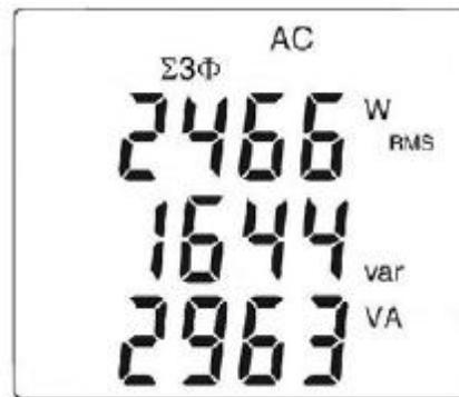
**提示：**你也可以在平衡 4 线电网上测量三相功率，通过同样的方式或如单相电网上的测量，然后将数值乘以三。
