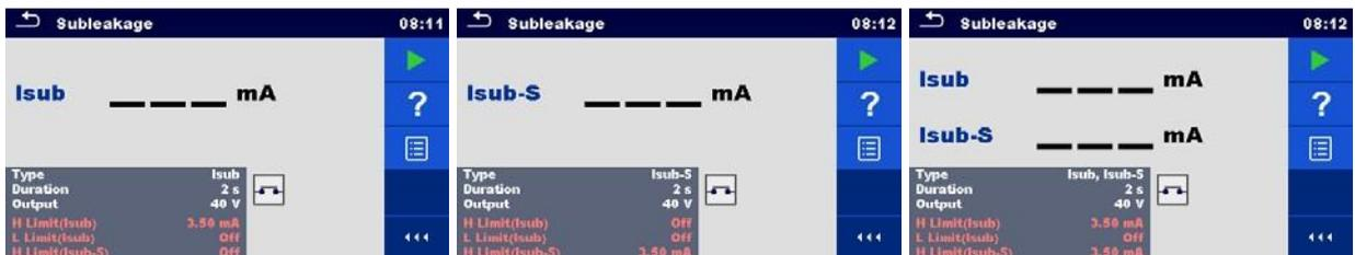
图 4.28: 临界漏电流测试菜单
