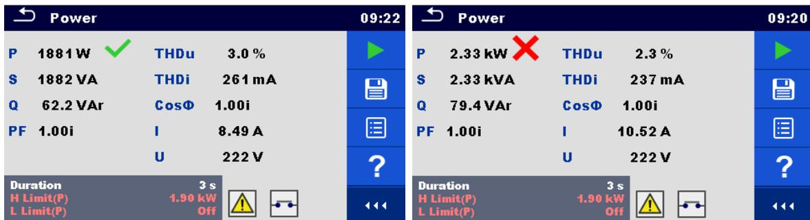
图 4.44: 功率测量结果示例
