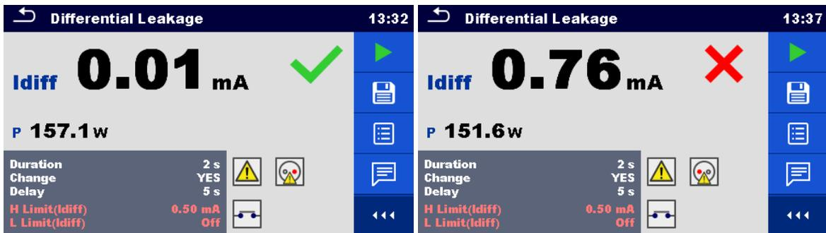
图 4.35: 差分漏电流测量结果示例
