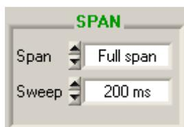
El **SPAN** representa la banda de frecuencia cubierta por el analizador durante el barrido de su señal de recepción.
