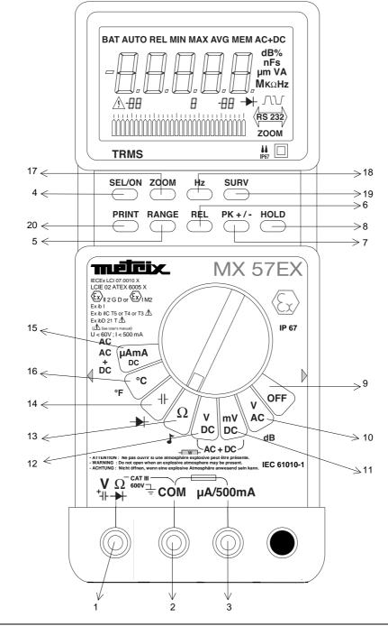
Multimètre digital portable de sécurité intrinsèque
