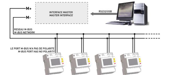
L'appareil peut communiquer si au moins 2 phases de tension lui sont connectées. The device can communicate when at least 2 voltage phases are connected.
